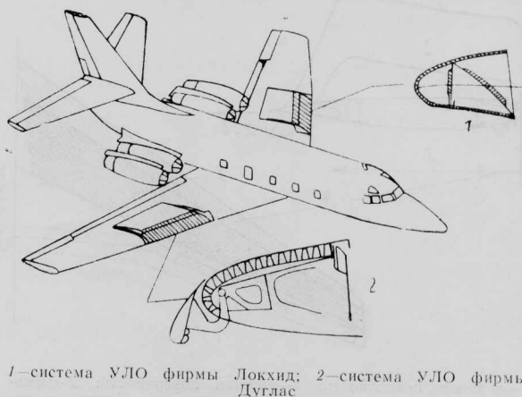
Рис. 5. Расположение панелей систем УЛО на модифицированном самолете «Джетстар»
