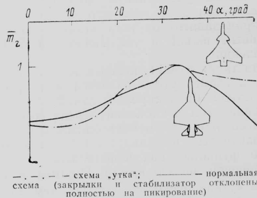
Рис. 6. Зависимости восстанавливающего момента на пикирование от угла атаки — схема «утка»; — нормальная схема (закрылки и стабилизатор отклонены полностью на пикирование)
